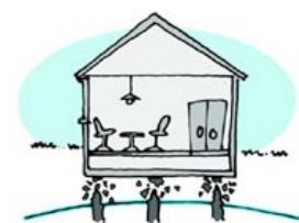
Grondwaterpeil te laag: paalrot
